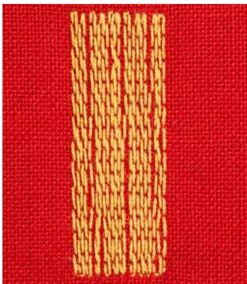
Простая программа штопки № 22 подходит прежде всего для быстрой штопки тонких мест или разрывов. Рекомендуется подкладывать тонкий материал или подклеивать самоклеющийся стабилизатор. Простая программа для штопки № 22 заменяет нитки основы на любом материале. Если место штопки перекашивается, можно воспользоваться функцией баланса (См. стр. 88).
