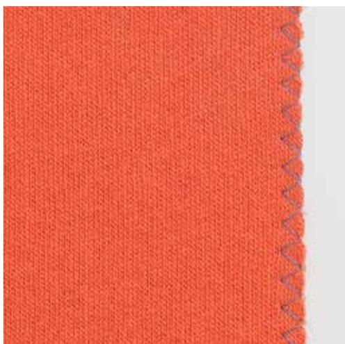
Строчка зигзаг № 2 подходит для всех тканей. Ее можно применять как при эластичных швах, так и для декоративных работ. Для тонких тканей нужно использовать штопальные нитки. Для гладьевого валика рекомендуется устанавливать плотный, короткий зигзаг с длиной стежка 0.5 – 0.7 мм. Гладьевой валик можно использовать для аппликаций и для вышивки.
