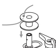
4. Проденьте конец нитки через внутреннее отверстие шпульки (см. рисунок) и насадите шпульку на штифт.
