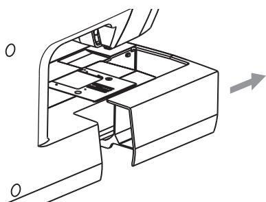
При снятой приставной швейной платформе на задней стороне рукавной платформы видна кнопка опускания транспортера.
