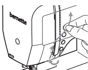
4. После этого нитку протягивают вниз и снизу обводят вокруг крышки нитепрятывателя.
