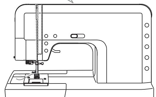
Нитка заправляется, как и при работе с одностержневой иглой и горизонтальным катушкодержателем. Заправьте левую иглу. Вставьте в соответствующее отверстие второй штифт (он входит в комплект принадлежностей машины).
