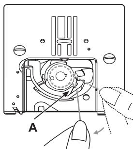
Затяните нитку в направлении стрелки под пальцем челнока (A) до нитеотклонителя (B) в прорезь.
