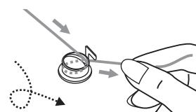
3. Обведите нитку по часовой стрелке вокруг регулятора предварительного натяжения.
