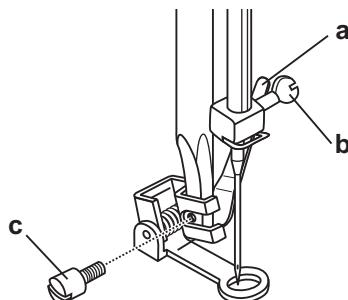
Снимите лапкодержатель и установите лапку для штопки.
