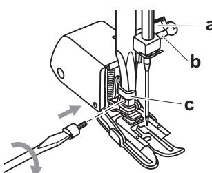
Закрепите лапку верхнего транспортера следующим образом:
