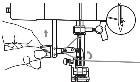
Нитевдеватель автоматически повернется в положение заправки нитки, а крючок пройдет через ушко иглы.
