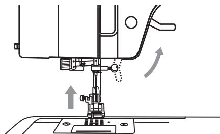
Лапка опускается и поднимается рычагом прижима ткани.
