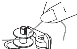
7. Процесс намотки запускается нажатием пусковой педали или кнопкой Start/Stop.
