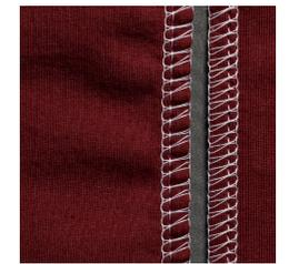
Differentialtransport in Grundeinstellung für flache und gleichmäßige Nähte.
