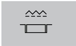
«Transporteur»-Taste 1 bündig mit Gehäuse.
