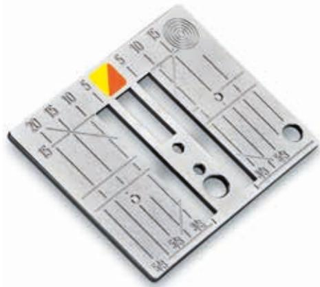
La plaque à aiguille pour point droit/CutWork possède un petit trou dans le secteur de l'aiguille. Le nouage des fils (fil supérieur et de canette) est ainsi amélioré. On obtient ainsi une plus belle formation de point.
