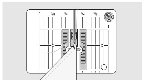
При обшивании уголка транспортер плохо перемещает материал, так как с зубьями транспортера соприкасается только часть материала.
