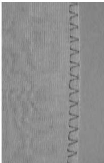
Оверлочная лапка № 2А предназначена специально для шитья оверлочных швов. Направляющее ребро этой лапки позволяет вшивать в шов достаточно большое количество нитки, что обеспечивает его эластичность.
