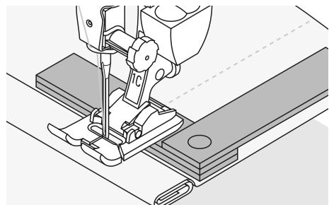
Для устранения наклона лапки при сходе с утолщения поместите одну или несколько компенсирующих пластинок справа от лапки вплотную к игле. Прошлейте до выправления положения лапки, затем уберите пластины
