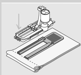
Если петля должна быть расположена под прямым углом к кромке материала, рекомендуется использовать пластину для компенсации утолщений материала (приобретается в качестве специальной, дополнительной принадлежности). Эту пластину вставьте сзади между материалом и подошвой лапки с салазками, придвиньте вплотную к
