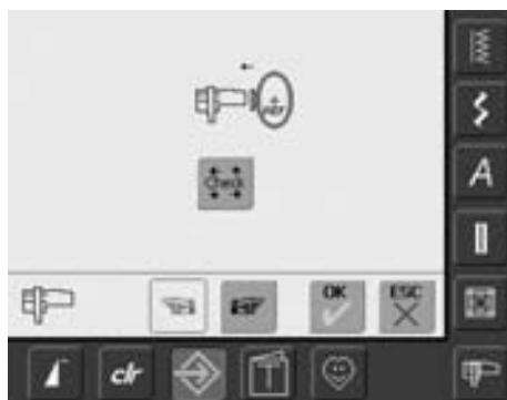
Юстировка пялец предназначена для согласования положения иглы в центре пялец. Юстировка может быть проведена только при подключенном вышивальном модуле и установленных овальных пяльцах. Она должна быть произведена только один раз, так как она действительна для пялец всех размеров.
