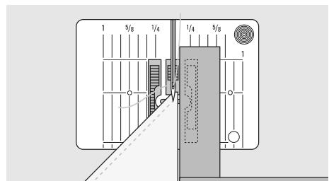
Если уложить с правой стороны лапки одну или несколько пластинок вплотную к краю материала, то подача транспортера будет более равномерной.
