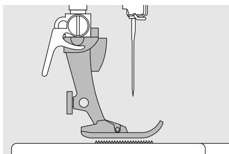
Транспортер может работать normally только в том случае, если лапка находится в горизонтальном положении.
