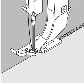
Il piedino n. 2 è stato sviluppato appositamente per i punti overlock. Il punto viene formato intorno alla staffetta del piedino, tenendo piatto il bordo della stoffa e garantendo l'elasticità del punto.
