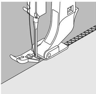
Il piegino n. 2 è stato sviluppato appositamente per i punti overlock. Il punto viene formato intorno alla staffetta del piegino, tenendo piatto il bordo della stoffa e garantendo l'elasticità del punto.
