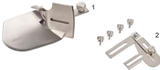
L'appareil à ganser simple pli sert à garnir parfaitement les bords de tissu et les encolures d'un biais. Le ruban non plié est introduit à travers le rail de guidage mis en place, rabattu sur le côté supérieur, tandis que le côté inférieur reste ouvert, puis cousu avec un point enveloppant. Pour un look personnalisé, il est aussi possible de confectionner soi-même le biais.
