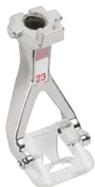
Ce pied-de-biche est idéal pour les travaux d'appliqués simples avec une couture chenille étroite de jusqu'à 2 mm. La semelle transparente de forme spéciale offre une vue parfaite sur la zone de couture et les points denses glissent parfaitement sous le pied, que ce soit sur les lignes droites ou sur les arrondis. Un fil d'accompagnement ou un ruban peut également être inséré dans l'évidement à l'avant.
