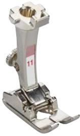
Ce pied-de-biche s'utilise pour la couture et la surpiqûre avec un cordonnet en fil supérieur ainsi que pour les motifs Sashiko et autres. La rainure de 2 mm de profondeur sur le dessous du pied garantit un bon avancement du fil supérieur plus épais sous la semelle.
