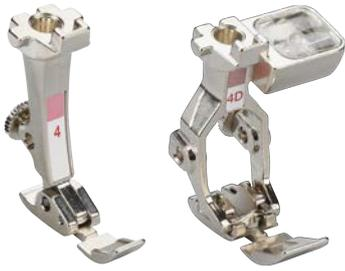
Ce pied permet de coudre rapidement des fermetures à glissière de façon nette et précise. La semelle étroite est dirigée près des dents de la fermeture à glissière afin de coudre précisément le long du rebord du ruban.
