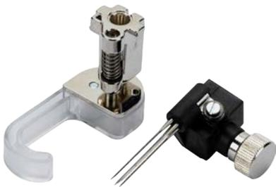
Le meilleur outil pour des travaux de feutrage à l'aiguille avec des fils de laine ou des fibres de laine lâches. Il permet de réaliser des dessins et motifs dans des tissus comme le feutre, la laine, le loden, les foulés ou le jean sans lycra. Cet outil doit être utilisé en combinaison avec la plaque à aiguille de 5,5 mm PunchWork.
