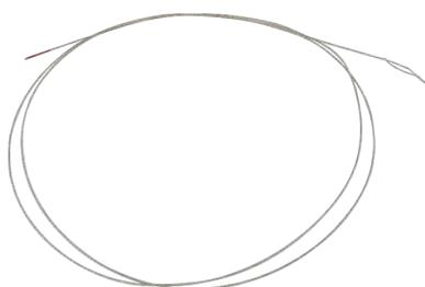
Le fil est utilisé temporairement si un des tubes de l'enfileur à air est bloqué. Une solution à court terme pour terminer l'ouvrage.
