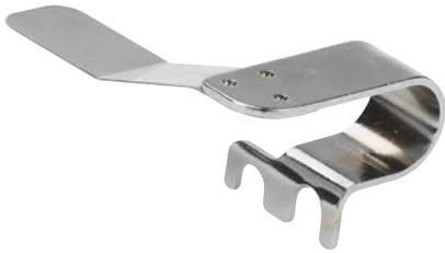
La languette guide sépare les deux couches de tissu. La couche inférieure est froncée tandis que la couche supérieure reste plate. Il est possible aussi bien de réaliser un simple fronçage que de froncer un tissu en le cousant simultanément sur un autre qui reste plat.
