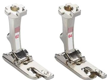
Combiné avec la plaque à aiguille pour point droit, l'ourleur étroit pour point droit permet de créer un ourlet très fin et garantit une piqûre d'une finition particulièrement soignée. Le tissu est replié deux fois pendant la couture et cousu à l'aide d'un point droit. Les pieds #62 et #64 sont utilisés pour des ourlets d'une largeur de 2 ou 4 mm.
