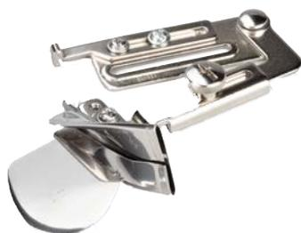
L'appareil à ganser est conçu pour entourer les bords avec un biais préplié d'une largeur de 13, 20 ou 25 mm. Il permet de réussir des angles parfaits et de magnifiques courbes effectués à l'aide d'un point utilitaire ou décoratif.
