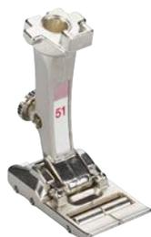
Grâce à ses trois roulettes sur la face inférieure, ce pied-de-biche facilite la couture du cuir, du vinyle, du plastique et d'autres matériaux glissant difficilement.
