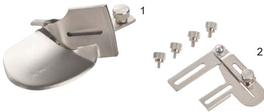
L'appareil à ganser double pli sert à garnir parfaitement les bords de tissu et les encolures d'un biais. Le biais non plié est introduit à travers le rail de guidage monté, rabattu sur les côtés supérieur et inférieur, puis cousu avec un point enveloppant ou de chaînette. Pour un look personnalisé, il est aussi possible de confectionner soi-même le biais.
