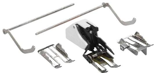
Le pied d'avancement supérieur favorise l'avancement du tissu. Il permet de coudre parfaitement à la machine les lignes droites d'un quilt et d'assembler avec précision des matières glissant mal ou élastiques qui ont tendance à se déplacer ou à se détendre légèrement. Les deux règles au bord du pied renforcent la précision du travail.
