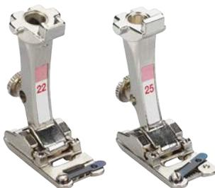
As ranhuras permite a colocação de vários fios ou fitas lado-a-lado para serem costurados em simultâneo, seguros no sitio pelo guia. Isto significa que o fio não necessita de ser guiado. O calcador #22 é desenhado para três fios e o calcador #25 para cinco fios.
