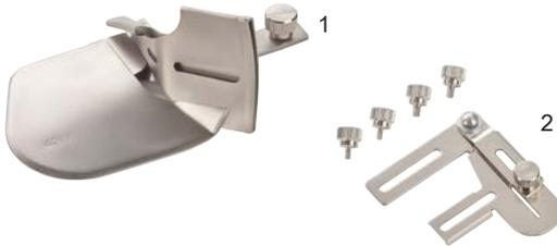
Com o aparelho para fita viés de uma dobra, as bordas do tecido e as golas podem ser rematadas de forma perfeita com fita de viés. A fita não dobrada é inserida na guia do aparelho, dobrada ao longo da borda superior enquanto a borda inferior permanece aberta sendo depois rematada com um ponto de recobrimento. Para um acabamento personalizado, a fita de viés pode ser cortada por si.
