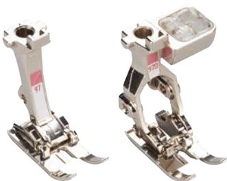
O calcador é ideal para criar acolchoados perfeitos e outros trabalhos precisos de costura. As marcas na sola para margens de costura de 3 mm (1/8"), 6 mm (1/4") e 7.5 mm (3/10") certifica que é corretamente guiado. A área de contacto do calcador é perfeito para máquinas com 9-mm de largura de ponto, e permite ter um ponto guiado e perfeito na junção de tecido.
