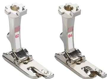
Usado em combinação com a chapa de agulha de ponto recto, o calçador para bainha de ponto recto cria bainhas com uma costura particularmente bonita. O tecido é dobrado duas vezes uma só operação enquanto costura com ponto recto. O calçador #62 e #64 são utilizados para produzir bainhas com 2 e 4 mm correspondentemente.
