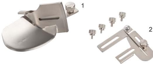
Com o aparelho para fita de viés de dobra dupla, as bordas de tecido e as golas podem ser rematadas de forma perfeita com fita de viés. A fita não dobrada é inserida na guia do aparelho, dobrada ao longo das bordas superior e inferior da fita de viés e costurada com um ponto de recobrimento ou ponto corrente. Para um acabamento personalizado, a fita de viés pode ser cortada por si.
