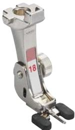
Este calçador ajuda a coser os botões e ganchos. A sola em borracha segura o botão fixo no sítio preciso para ser costurado. A altura do suporte pode ser ajustada através do parafuso no centro, dependendo da grossura do tecido.
