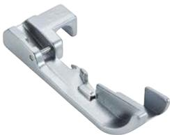
Com o calçador de missangas e lantejoulas, fios de missangas e lantejoulas com um máximo de 6 mm de diâmetro podem ser costurados com facilidade e rapidez. É utilizado para criar acabamentos no fim dos tecidos ou ao longo de costuras planas. A ranhura na sola do calçador e o guia na lateral segura o fio de lantejoulas e assegura que pode ser cosido sem sair do veio. Em combinação com o guia direito como apoio, a costura pode ficar mais precisa.
