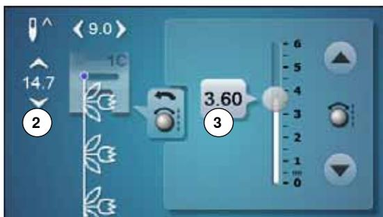
En las otras muestras de punto, alfabetos inclusive, está indicado el largo total de una muestra de punto **2**. El largo del punto efectivo **3** está solo visible con el display abierto del largo del punto.
